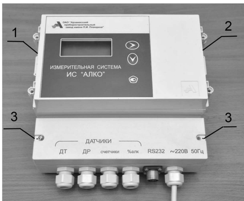
1 – пломба завода-изготовителя; 2 – знак поверки; 3 – пломбы специалиста, проводившего пуско-наладочные работы Рисунок 2 – Общий вид СВ, места пломбирования и нанесения знака поверки
